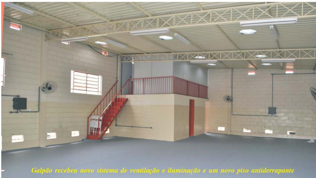
Galpão recebeu novo sistema de ventilação e iluminação e um novo piso antiderrapante
